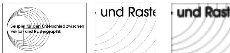
**Abbildung 9: Die Ausschnittsvergrößerung einer Vektorgraphik bleibt exakt (Bild, mitte), im Gegensatz zum Fall einer Rastergraphik (Bild, rechts)**
