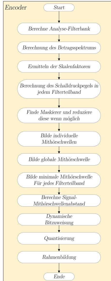
Abbildung 5.13.: Flussdiagramm des Encoders
