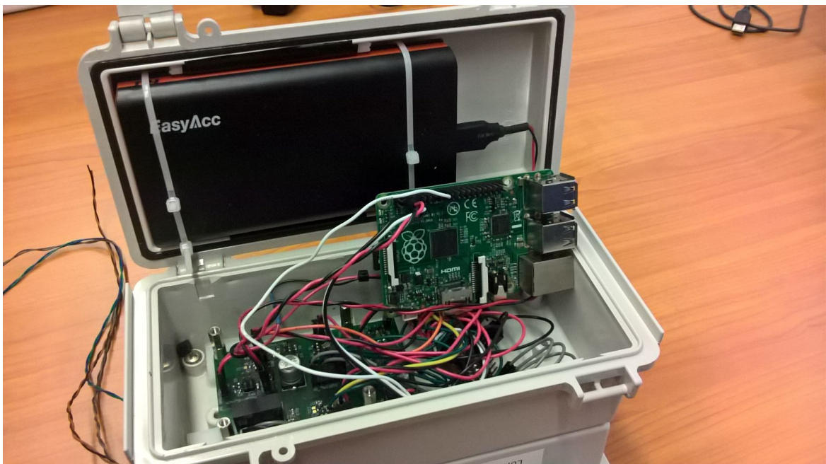
Abbildung 6.2.: Einbau Spannungsversorgung und Datenspeicherung
