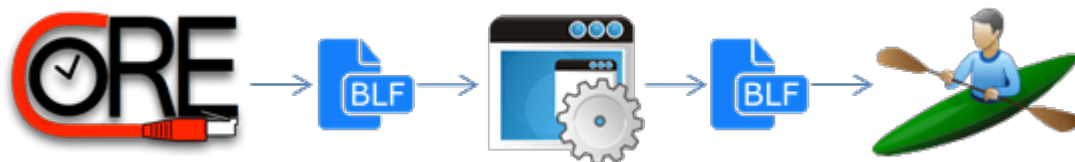
Abbildung 10: Die Aufbereitung der Simulationsdaten findet nicht in OMNeT++ statt, sondern in einer externen Applikation. Sie berechnet aus den in der ersten BLF-Datei enthaltenen Nachrichten die Metriken und schreibt sie wiederum in eine BLF-Datei, welche dann von CANoe eingelesen und angezeigt wird.
