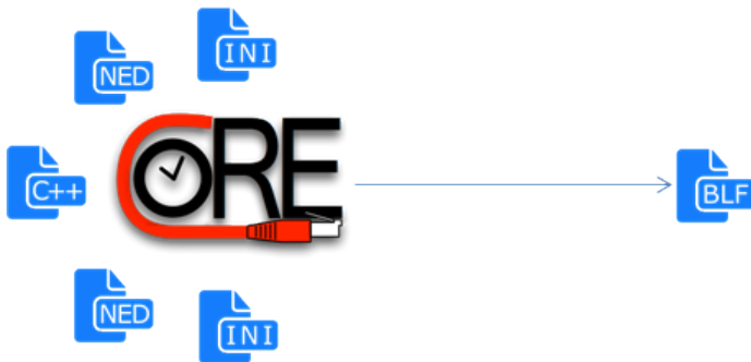
Abbildung 13: Schematische Darstellung der Simulation in OMNeT++ mit einer BLF-Datei, in welcher die Ergebnisse der Simulation festgehalten werden.
