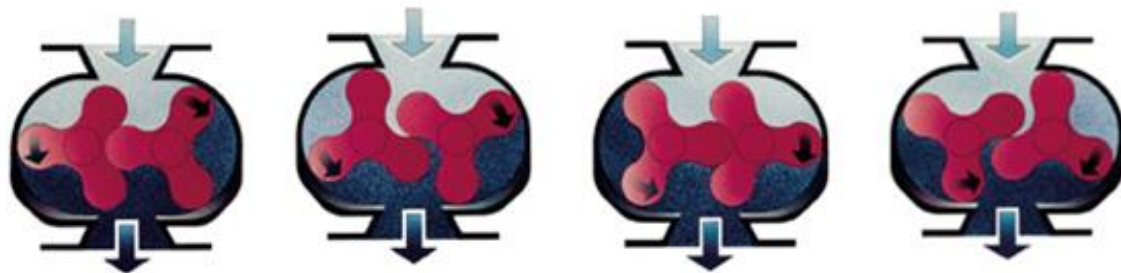
Abbildung 2.6: Arbeitsweise von Drehkolbengebläsen [14]
