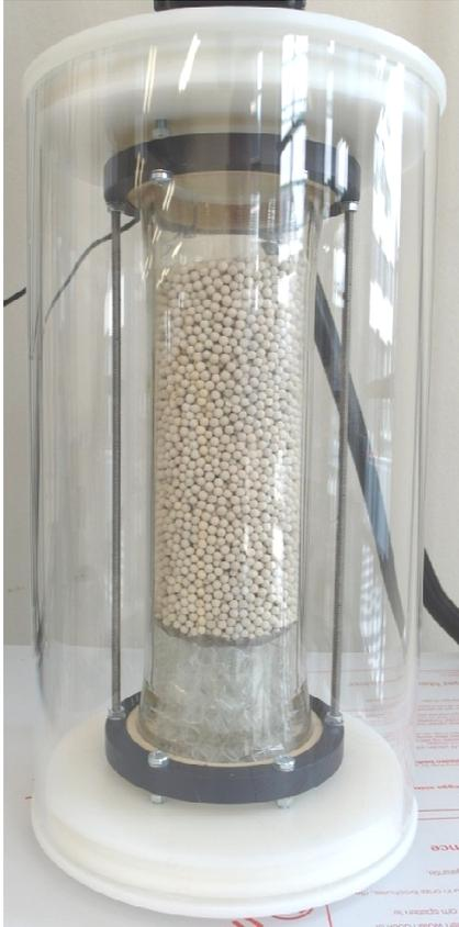
*Abbildung 5.1 Zeolithwärmespeicher mit Plexiglasisolierung*
