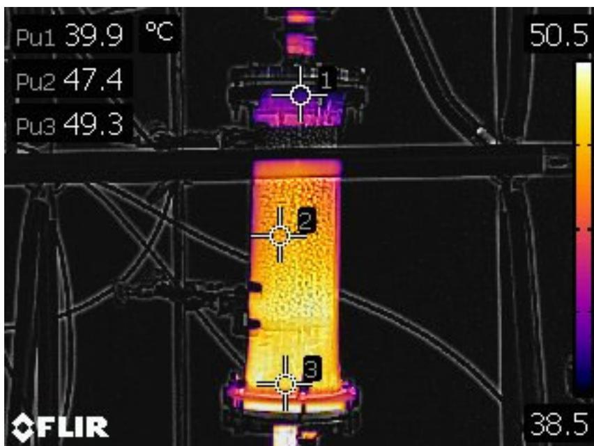
Abbildung 3.11 Bild der Wärmebildkamera am Versuchsende mit drei Temperaturmesspunkten
