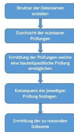
Abbildung 6-3: Vorgehensweise der Prüfprofilerstellung
