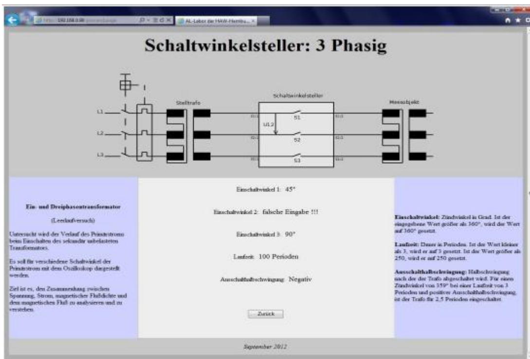
Bild 5-38: Dreiphasiger Betrieb des Schaltwinkelstellers
