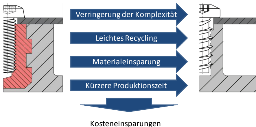
Abbildung 3-10 Verschraubungen mit Gewindeeinsätzen und Direktverschraubungen (Teile aus: [34])
