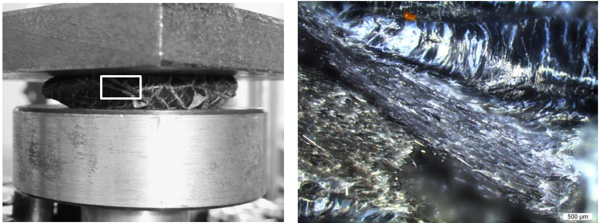
Abbildung 8-2 Ansicht der zerstörten Probe PP-GF 30 unter dem Mikroskop (500 \mu\text{m} )
