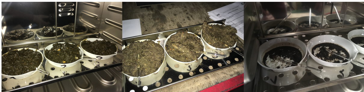
Abbildung 3.3: Tiegel mit Trockenrückstand (links vor, in der Mitte während und rechts nach der Trocknung (andere Probe))
