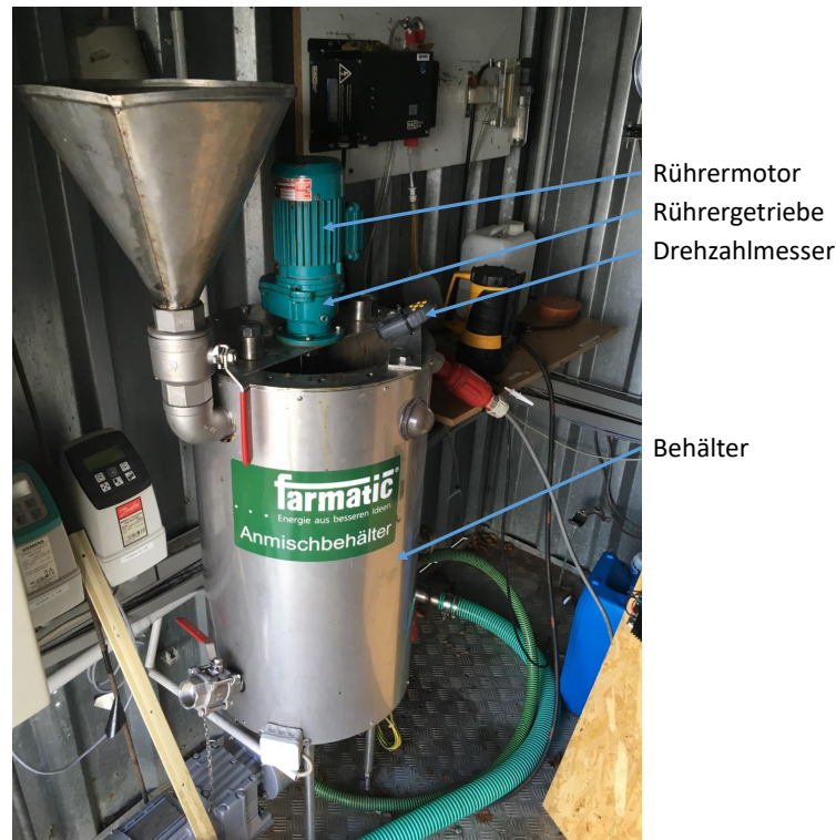
Abbildung 3.10: Blatt-Rührrheometer mit Motor, Getriebe und Drehzahlmesser
