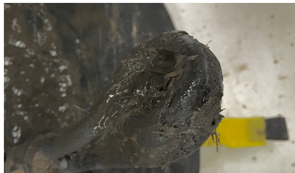
Abbildung 4.9: Tauchsieder mit angebranntem Rezirkulat
