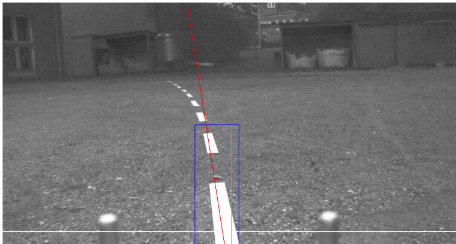
Abbildung 5.5: erfolgreiche Fahrspurerkennung bei einer Linkskurve
