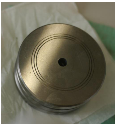
Abbildung 18 Prüfkörper mit Verschleißspuren
