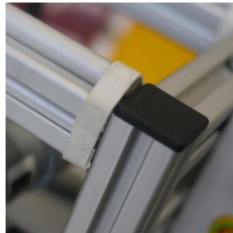
Abbildung 5 Befestigung der Rundstangen am Rahmen
