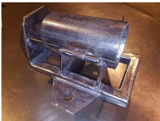
Abbildung 38: gefertigte Konstruktion mit geschlossenem Sicherheitsdeckel [4]
