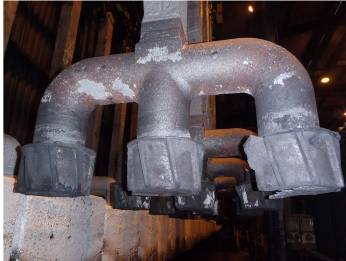
Abbildung 8: Anodenjochzapfen mit Hülsen [4]
