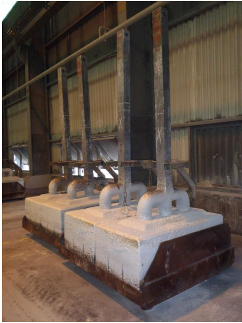
Abbildung 6: Anode vor Einsatz [4]
