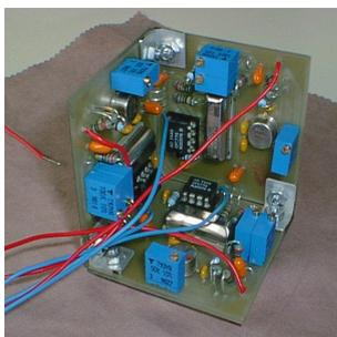
Abbildung 2.5.: Gyroskopisches System
