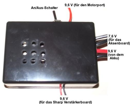
Abbildung 8.7.: Spannungsverteiler
