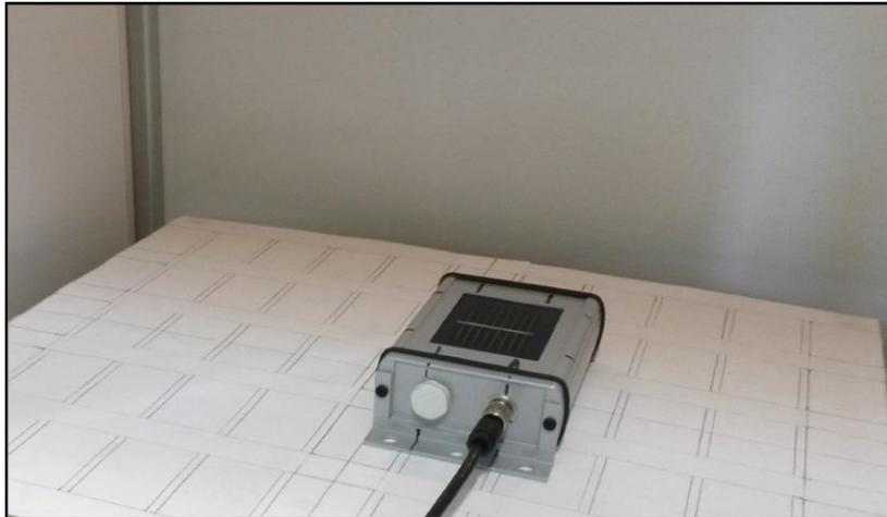
**Abb. 7.1:** Vorbereitete Messfläche mit Solarstrahlungssensor
