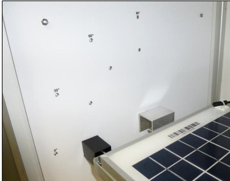
**Abb. 6.10:** Modulhalterung mit Winkeljustierblech
