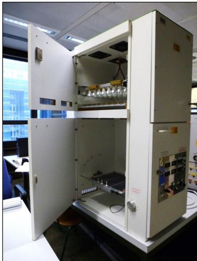
**Abb. 3.1:** Vorgängermodell, Blick in Lampen- und Modulkammer
