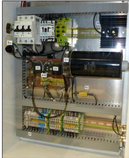
**Abb. 3.3:** Lampenversorgung auf der Rückseite des Gehäuses
