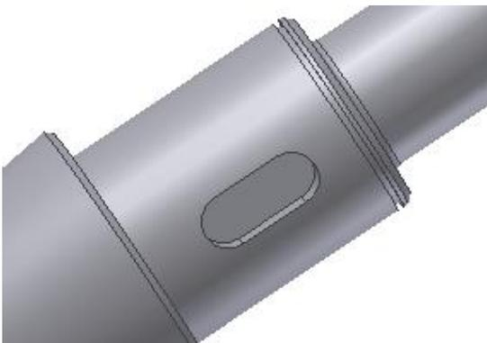
*Abbildung 2.2: Wellen-Generator: Keilnut, Nut für Sicherungsring [01]*
