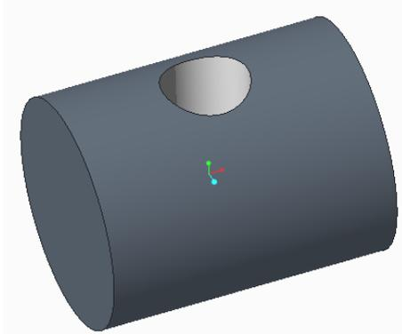
Abbildung 3.15: 3D Modell: Zylinder mit Radialbohrung
