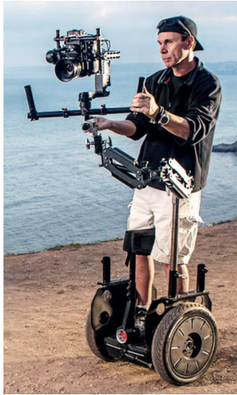
Abbildung 7.2: Gimbal-System mit einem Federarm an ein Segway montiert - http://www.dji.com/product/ronin/feature
