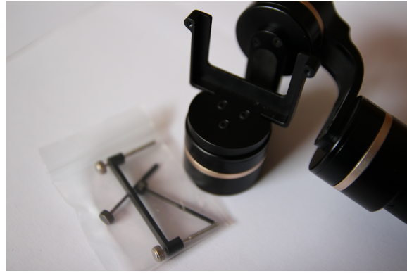
Abbildung 5.2: Kameraaufhängung und Montagebügel des FeiyuTech G4
