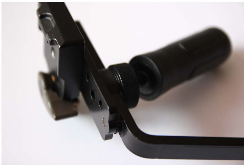
Abbildung 5.6: Stativplatte und Handgriff des Schwebi sc
