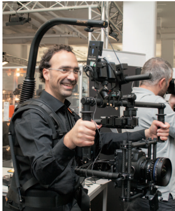
Abbildung 7.1: Gimbal-System montiert an einem Easy-Rig - Videoaktiv Ausgabe 2/2015
