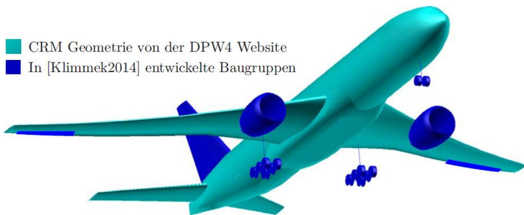
Abbildung 4.1: CRM mit von Herrn Klimmek entwickelten Baugruppen ( Klimmek 2016 )
