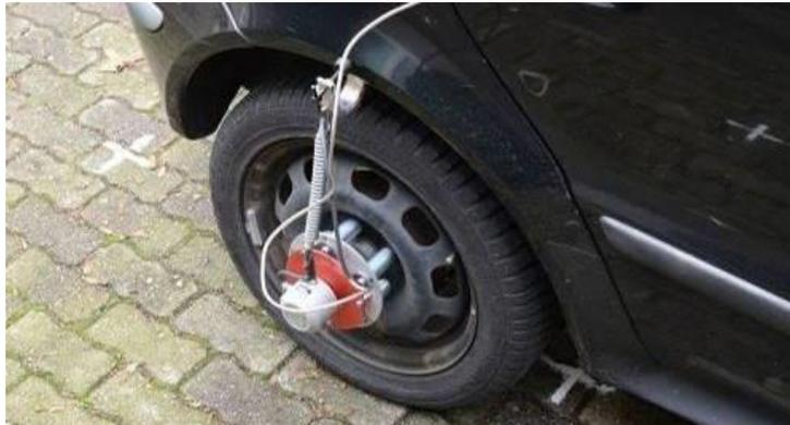
Abbildung 46 A-Klasse Rechtes Hinterrad mit Peiselerrad
