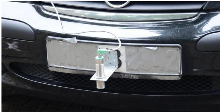
Abbildung 47 A-Klasse Front mit Ultraschallsensor
