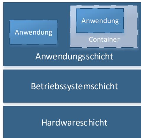
**Abbildung 7: Schichtenmodell Container-Virtualisierung**
