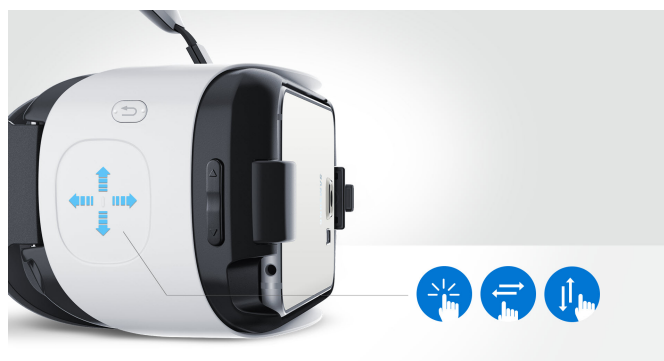
Abb. 3.12: Touchpad am Gear VR -Headset
