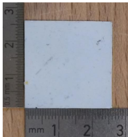
Abbildung 2-10: beschichtetes MLI-Blech, 26 x 26 mm, [Ver16]
