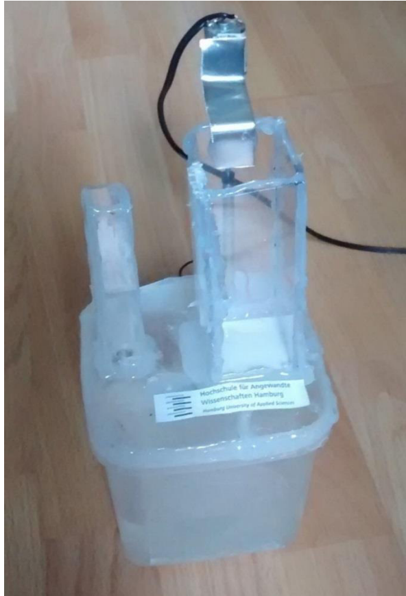
Abbildung 12: Messaufbau zur Ermittlung der Eigenschaften von Peltier-Elementen
