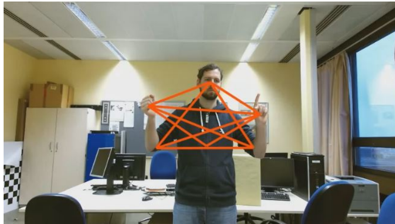
Abbildung 4.3.: Die berechneten Distanzen zwischen einzelnen Joints, die sich während einer Geste verändern.
