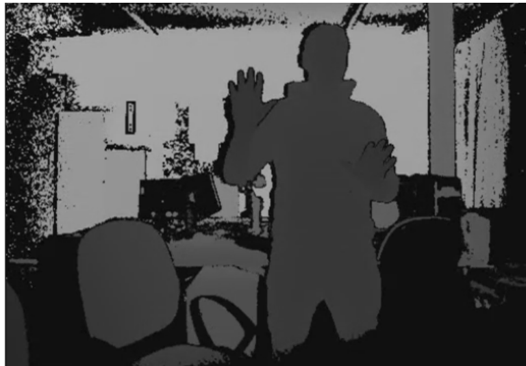
Abbildung 2.1.: Das Tiefenbild der Kinect 2, bereitgestellt von der Kinect SDK.
