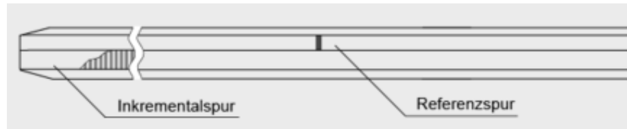
Abbildung 14: Aufbau des verwendeten inkrementellen Maßkörpers. Entnommen aus Quelle [22]
