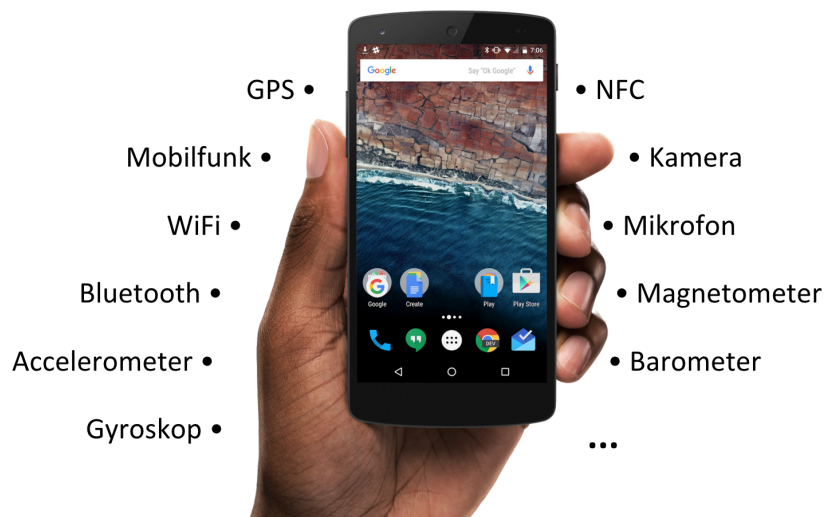
Abbildung 2.1: Im Smartphone verbaute Sensoren [Eigene Darstellung auf Basis von Handskit 1 ]
