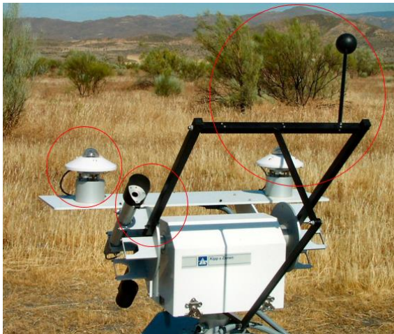
Abbildung 29. Messstation zur Messung der Global-, Direkt-, und Diffusstrahlung [11]
