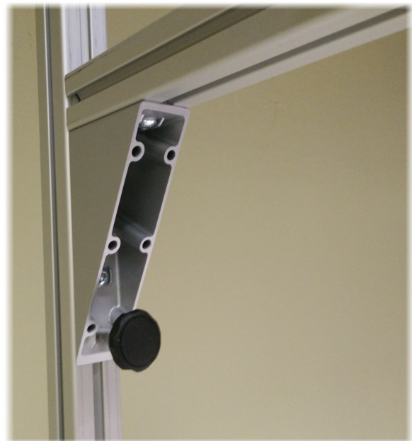
Abbildung 6.16: Auslegerbefestigung mit Sterngriffeststeller
