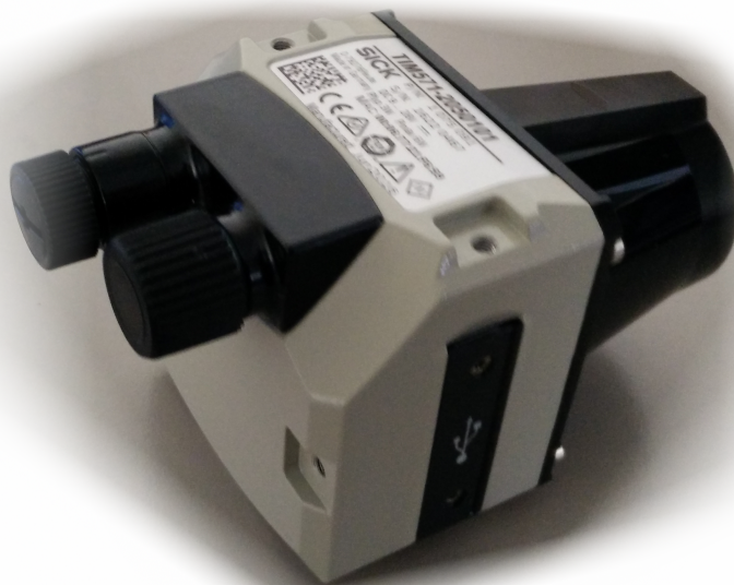
Abbildung 6.15: Laserinfrarotsensor TIM571 (Rückansicht)
