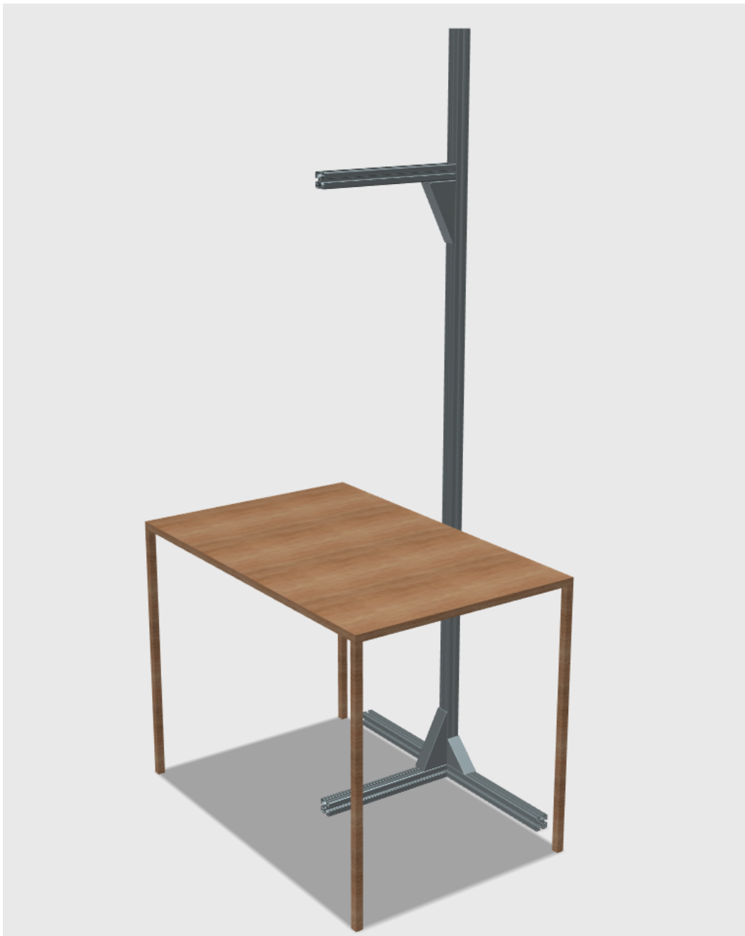
Abbildung 4.3: Virtueller Demonstrator-Aufbau final (Screenshot aus 123D ® Design)
