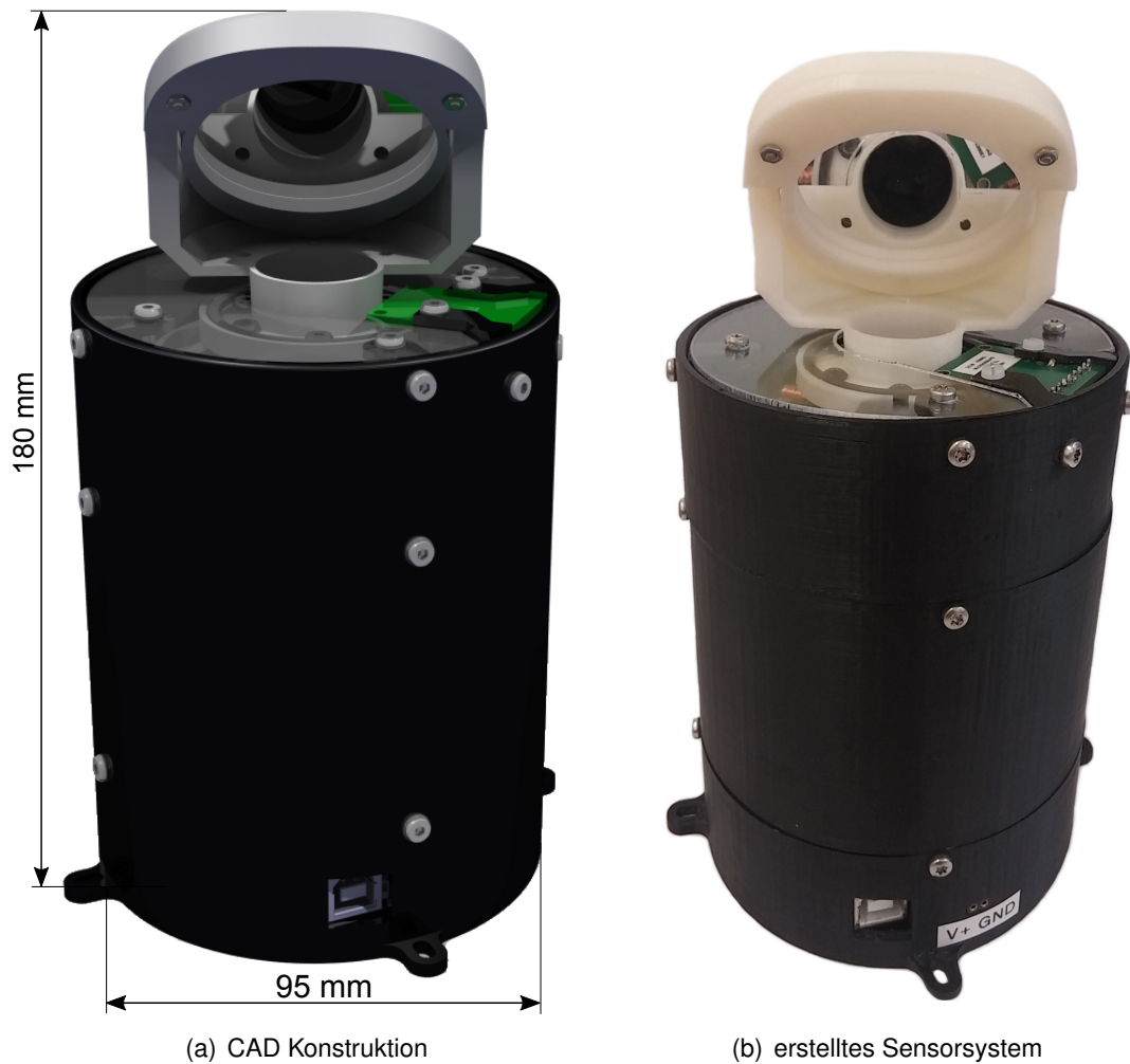
Abbildung 3.6.: Finaler Aufbau des 2D-Laserscanner
