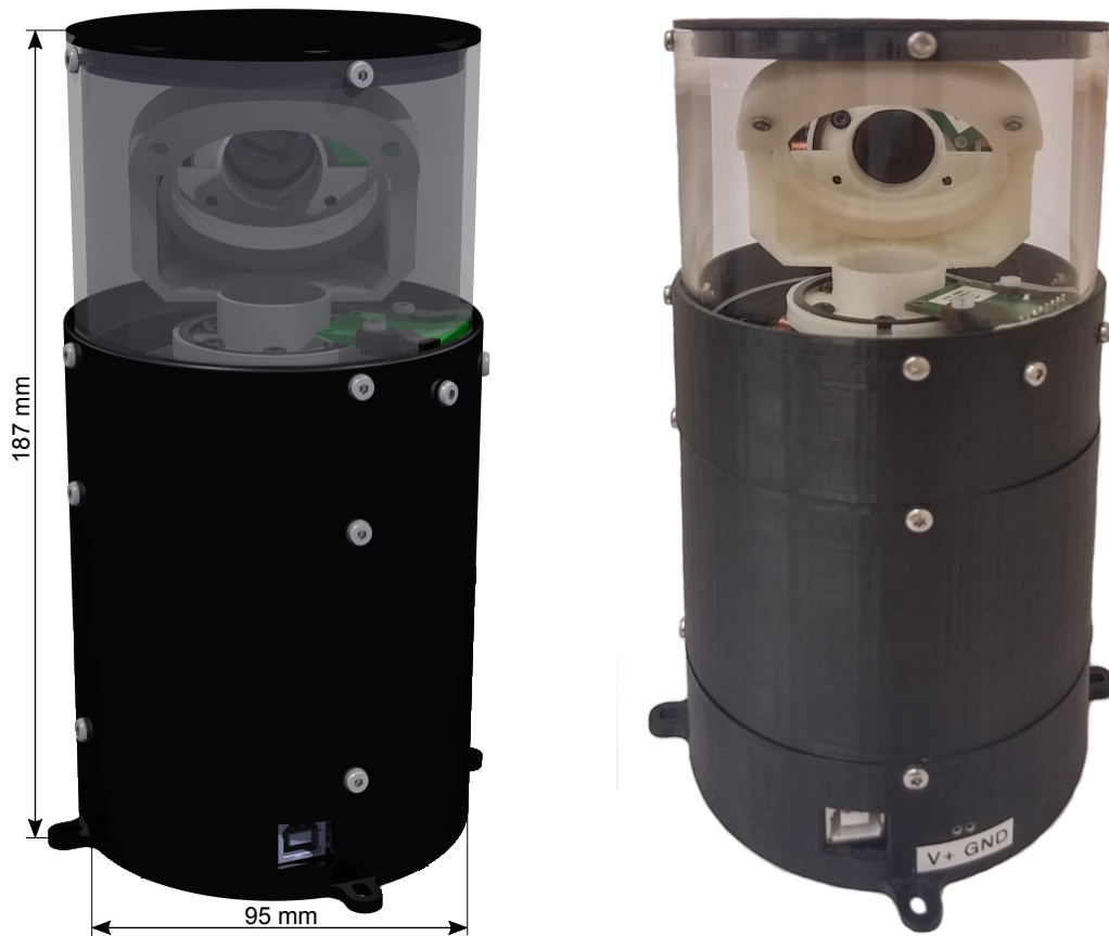
Abbildung 3.7.: 2D-Laserscanner mit Acrylglasabdeckung
