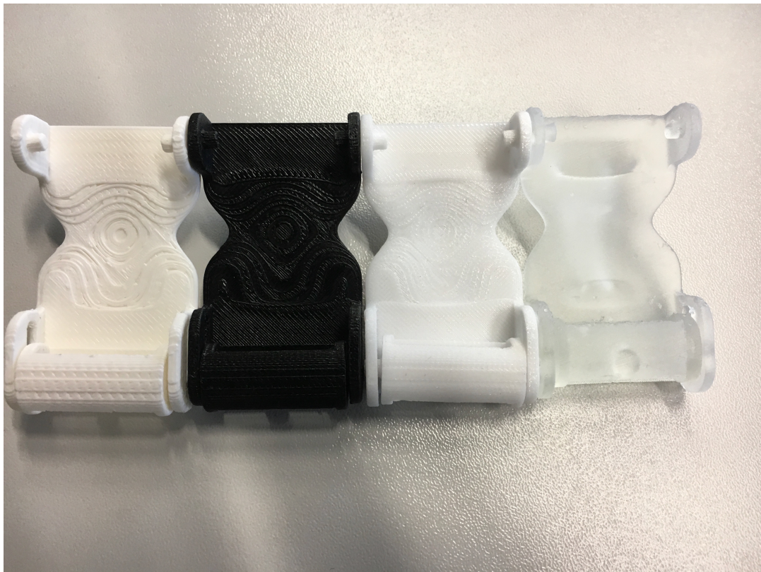
Abbildung 3.9: Vergleich der Materialien von links nach rechts: ABS, Nylon, Polycarbonat, Harz
