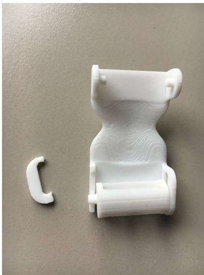
(a) Bruch des Versuchsteils
