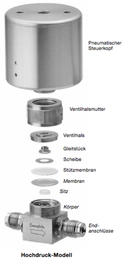
Abbildung 2.9.: Aufbau eines Swagelok-Membranventils [Quelle: Swagelok 2 ]
