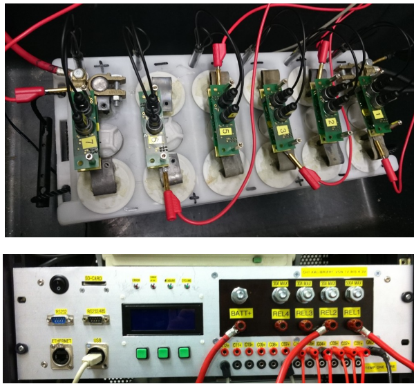
Abbildung 5.4.: Oben: Batterie mit eingesteckten Messsonden und an den Batterieelektroden aufmontierte Sensoreinheiten. Unten: Zykliergerät
