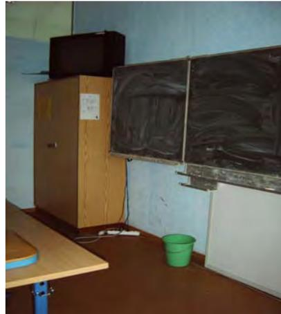
Abb. 20: Ungesicherte Verlängerungskabel
