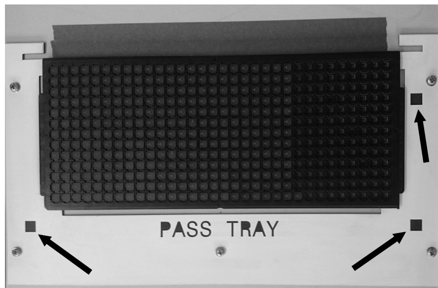
Abbildung 4.15.: Tray Halterung mit drei integrierten, quadratischen Referenzmarkern
