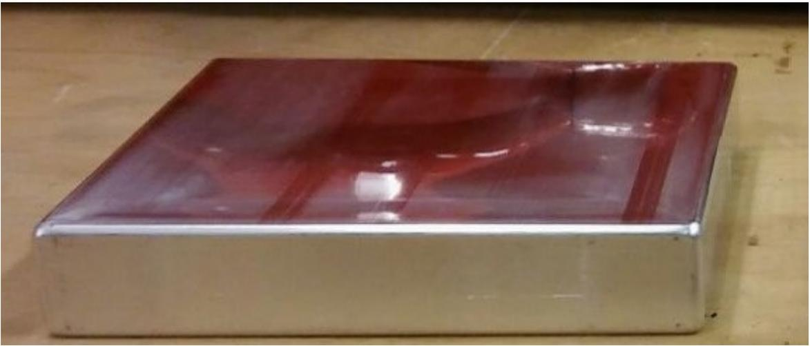
Abbildung E.1.: Foto einer neuen Lithium-Titanatzelle
