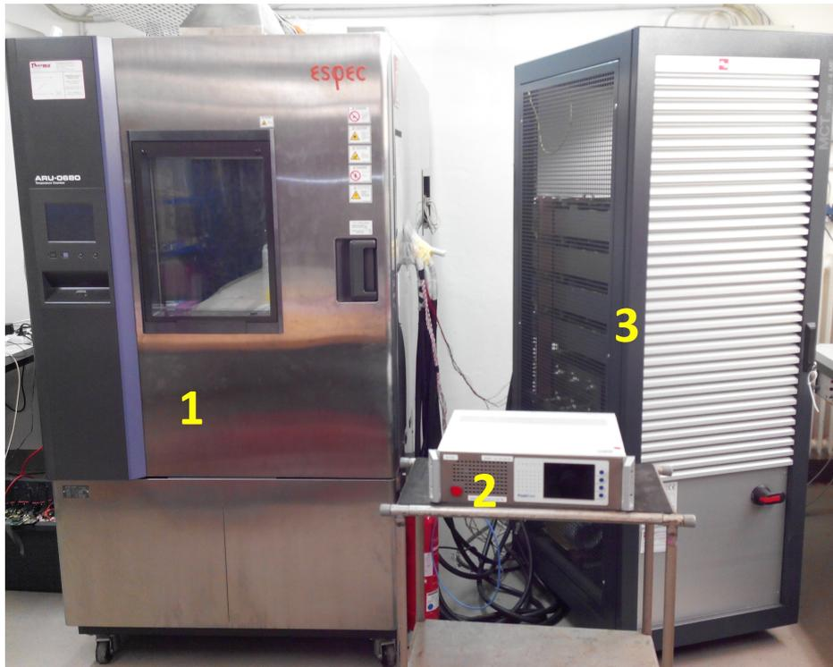
Abbildung 2.7.: Verwendete Geräte: 1 - Temperaturkammer, 2 - Impedanzspektrum-Analysator, 3 - Zellentester von Digatron
