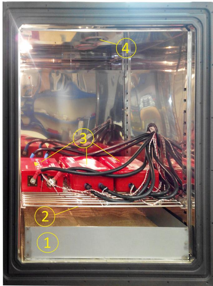
Abbildung 4.1.: Messaufbau der Sicherheitskonzept: 1-Sandkiste, 2-Gitter, 3-Metallboxen mit Testzellen, 4-Abluftkanal
