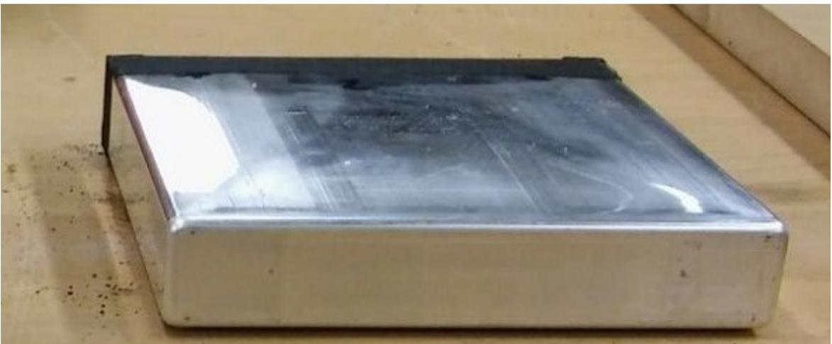
Abbildung E.2.: Foto einer aufgeblähten Lithium-Titanatzelle
