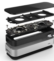
Abb. 5.27: Das Innere einer Leap Motion. Quelle: ( Col14 )
