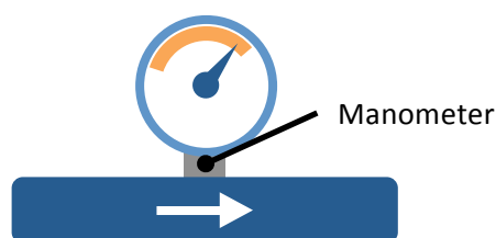
Abb. 28 Druckmessung: Ein Manometer – analog oder digital – zeigt den vorherrschenden Druck an der Messstelle an. Digitale Druckmesser können diese Daten direkt in das Leitsystem einspeisen.
