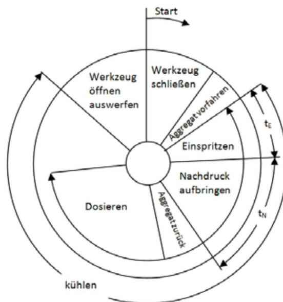
Abbildung 2.17: Zeitlicher Ablauf des Spritzgießzyklus [MGKE]
