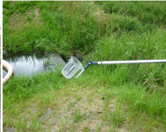
Abb. 11: Probenahmegerät „Ekman-Greifer“ Abb. 12: Oberflächenwasserschöpfer
