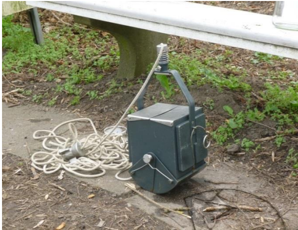
Abb. 11: Probenahmegerät „Ekman-Greifer“ Abb. 12: Oberflächenwasserschöpfer
