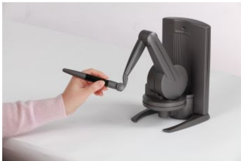
Abbildung 2.2: Phantom, Ein 3D Eingabestift mit haptischem Feedback, Quelle: http://www.geomagic.com/de/products-landing-pages/haptic/
