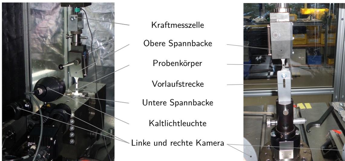
Abbildung 3.4: Versuchsaufbau der In-House Zug-Materialtests: Quasistatisch (links) und dynamisch (rechts)
