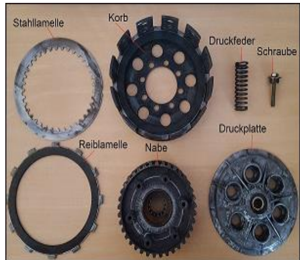
Abbildung 4-11: Einzelteile Ansicht einer Lamellenkupplung
