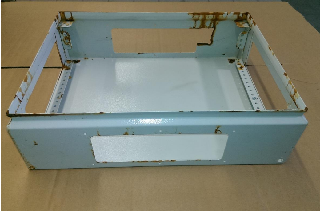
Abb. 11; Rittal Box, Salzsprühtest
