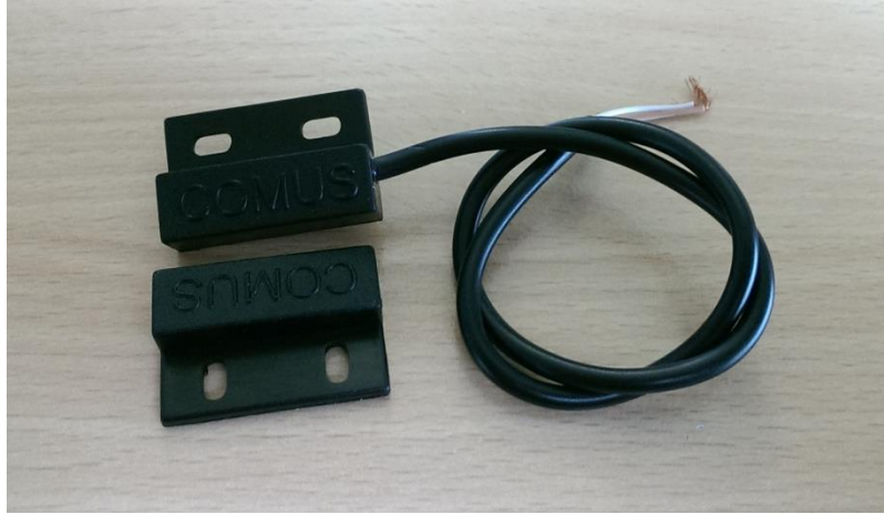
Abb. 17; Reedkontakt mit Magnetschalter
