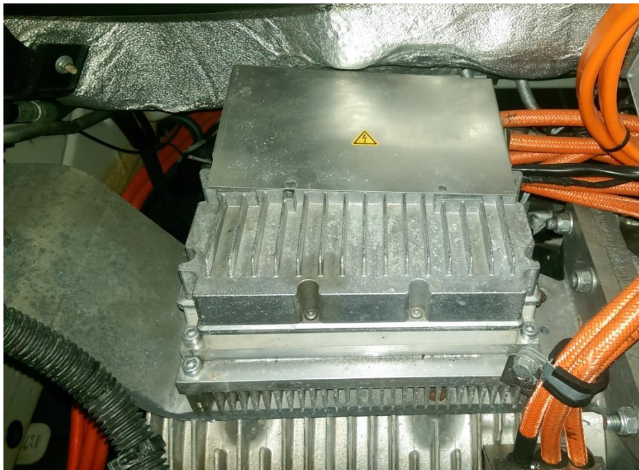
Abb. 3; Inverter auf dem E-Ducato 1.0 Motorträger
