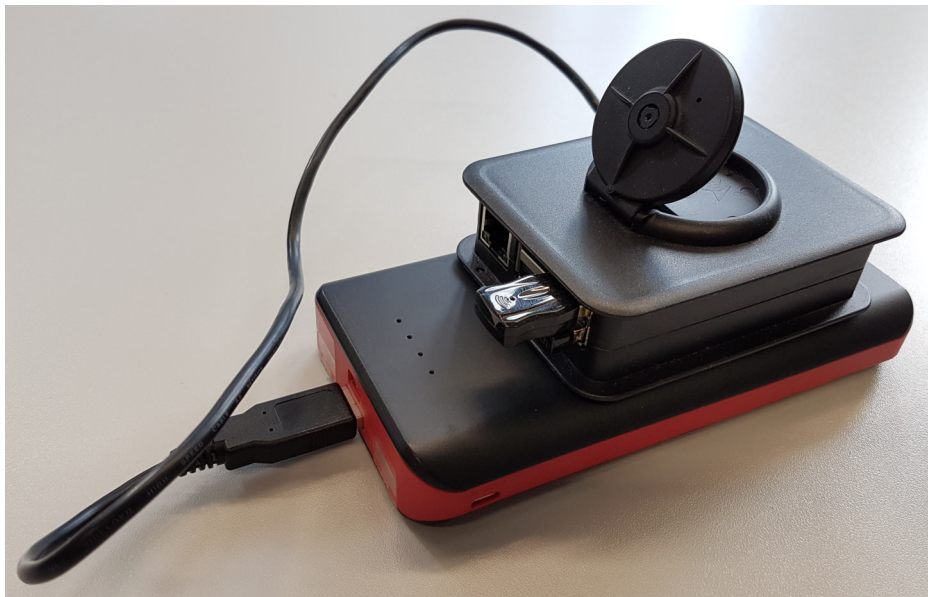
Abbildung 2.4.: Einplatinencomputer Raspberry Pi 2 B mit Kameramodul, WLAN-Stick und Powerbank
