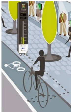
(a) Funktionsschema der Zählsäule (hier mit einer Schleife)
