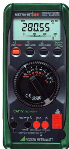
Abbildung 2.7.: Multimeter METRA HIT 26S
