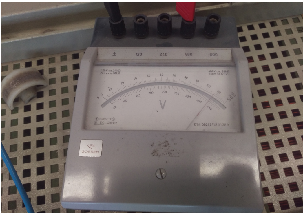
Abbildung 2.13.: Voller Spannungsausschlag am Transformator
