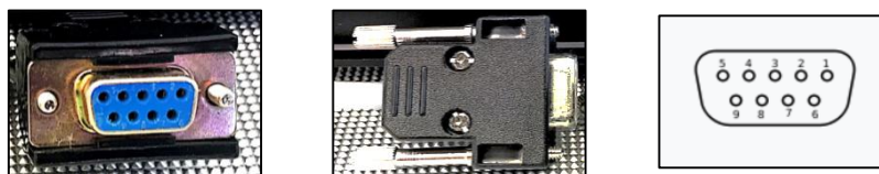
Abbildung 73: Sub-D-Stecker weiblich, links Vorderansicht, mittig Draufansicht, rechts Belegungsplan [29]
