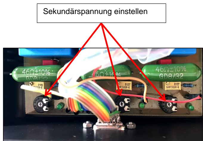
Abbildung 78: Sekundärspannung einstellen auf dem UI-Interface
