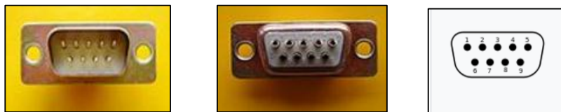
Abbildung 72: Sub-D-Stecker männlich, links Vorderansicht, mittig Lötansicht von hinten, rechts Belegungsplan [29]
