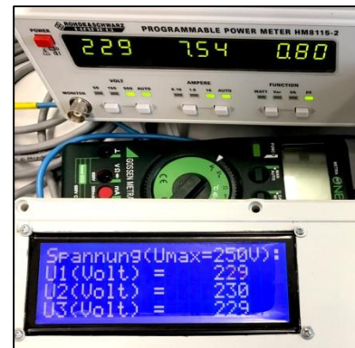
Abbildung 91: Wechselspannung von 229 V
