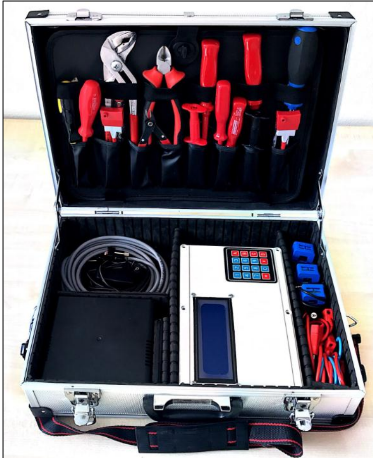
Abbildung 88: Anordnung Drehstrom-Leistungsmesseinrichtung im Alu-Koffer
