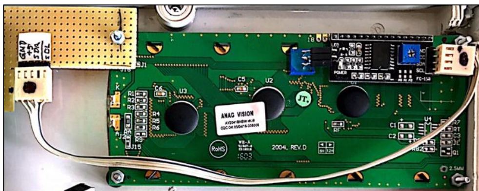
Abbildung 70: Oben links die 4 Anschlüsse und oben rechts das I 2 C-Modul
