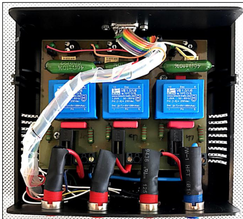
Abbildung 81: UI-Gehäuse offen, Anschlüsse im Inneren
