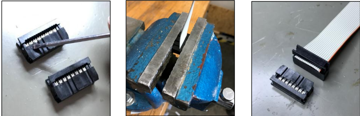
Abbildung 77: Klemmstecker vor, beim und nach der Verarbeitung
