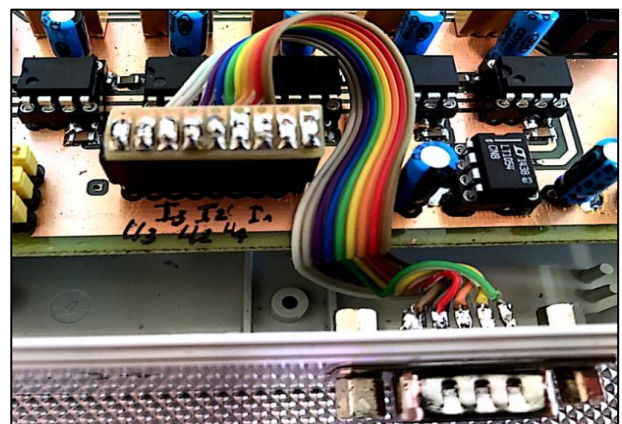
Abbildung 75: Verbindung Sub-D-Stecker mit der Platine im Mess-Gehäuse
