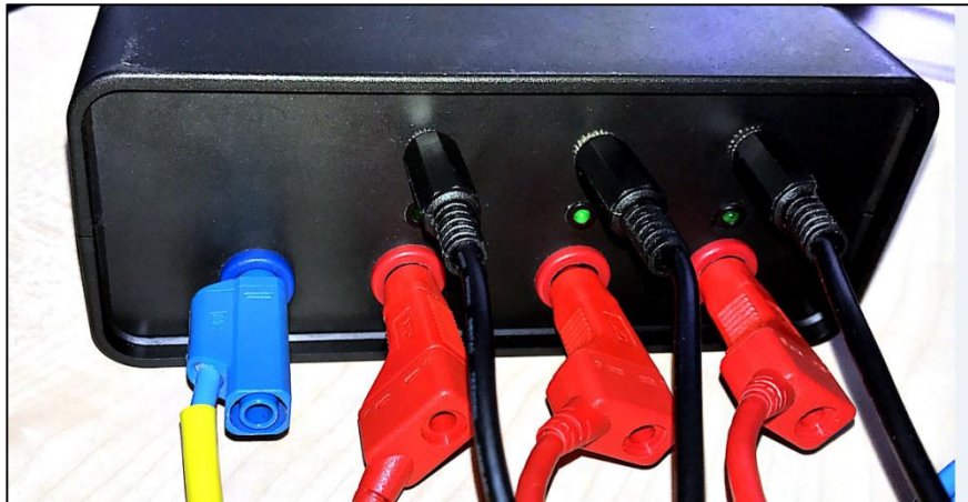
Abbildung 84: UI-Gehäuse mit Spannungskabel(rot/blau) und Stromwandler(schwarz)
