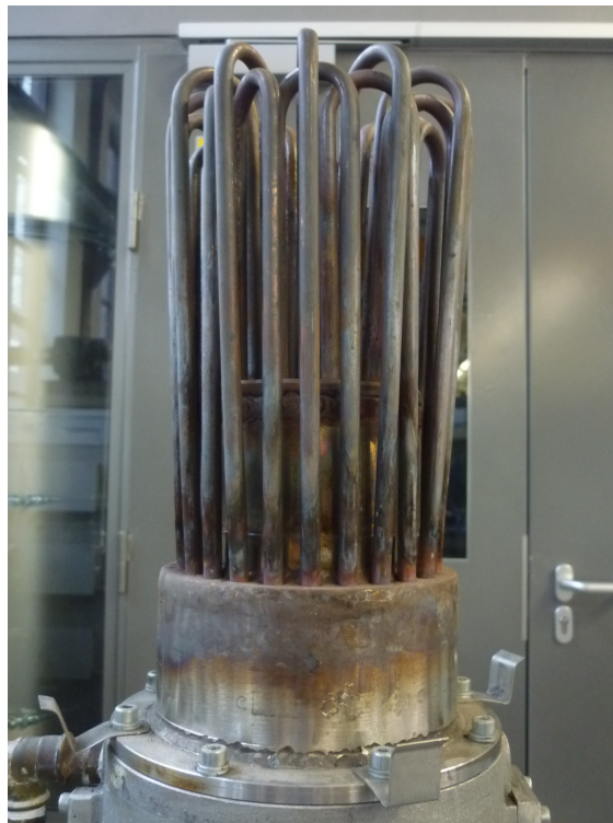
Abbildung 3.2.3. – Erhitzerkopf des ST 05 G im ZET
