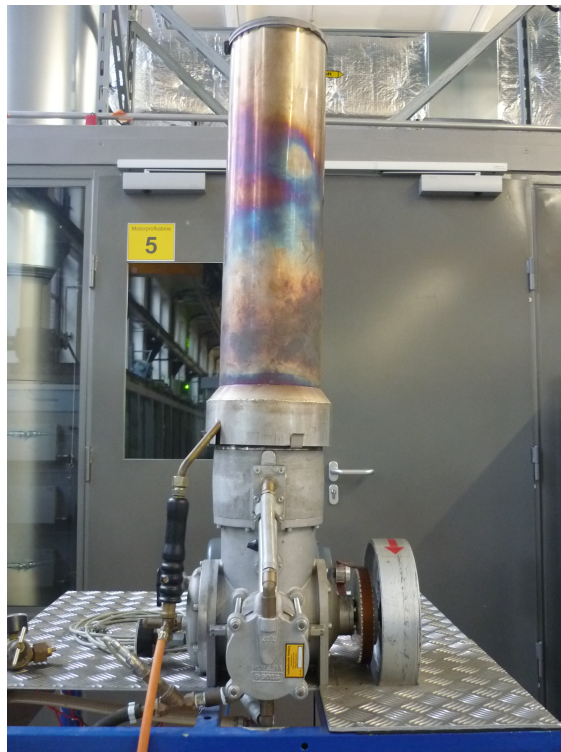
Abbildung 3.2.6. – ST 05 G mit Ringbrenner und Haube
