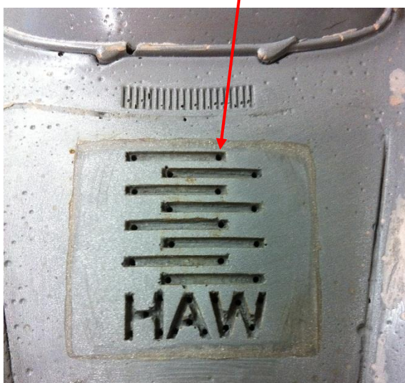
Abb. 9.3 Entlüftungsbohrungen im HAW Emblem
