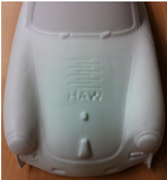
Abb. 9.1 unsauber ausgeformtes HAW Emblem
