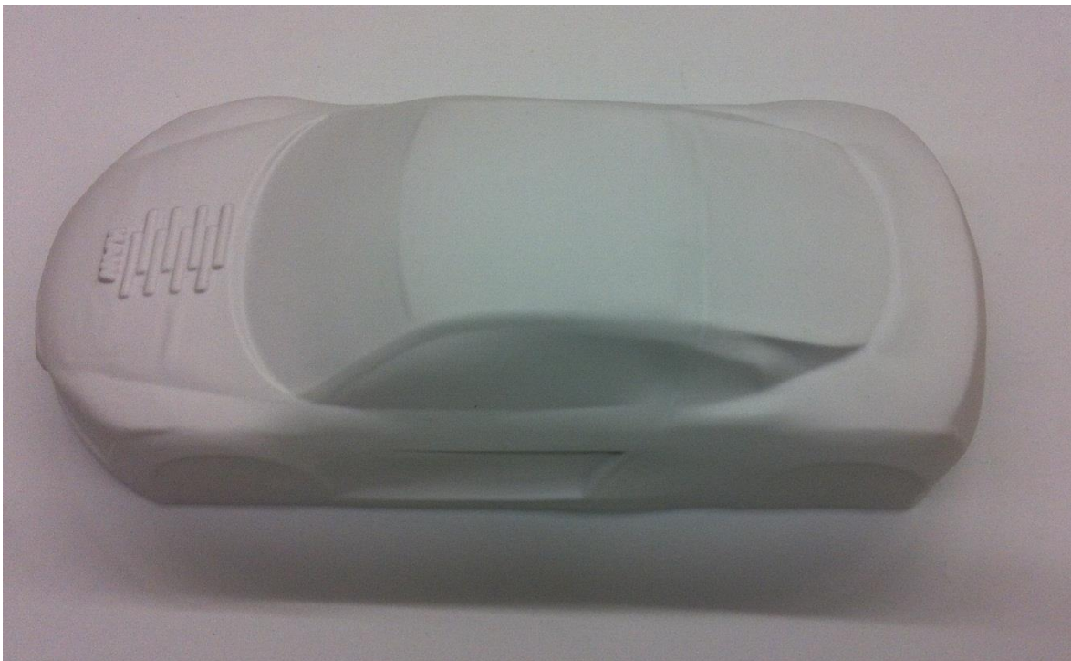
Abb. 9.16 optimale Abformung des Audi R8
