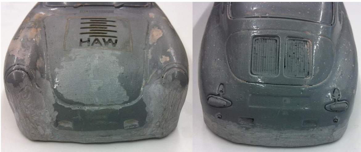
Abb. 9.5 entfernen der Hinterschneidungen
