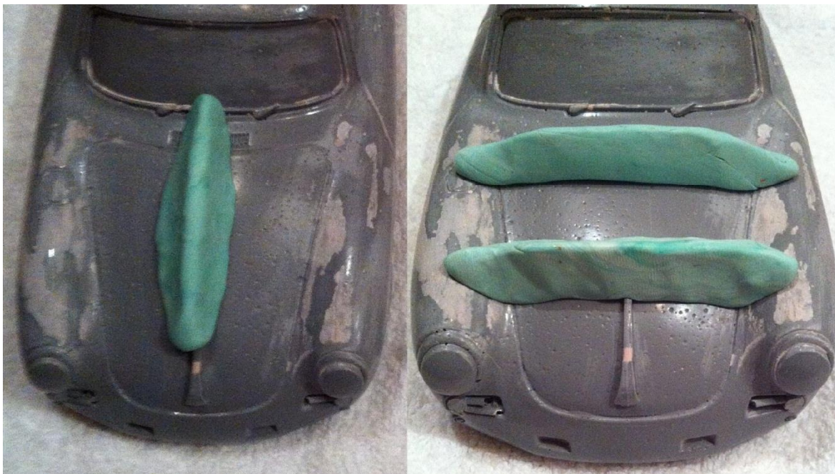
Abb. 5.8 Formermittlung der Motorhaube
