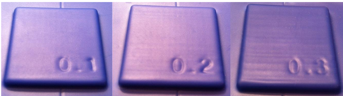
Abb. 6.3 Oberflächenqualität durch Schichtdicke
