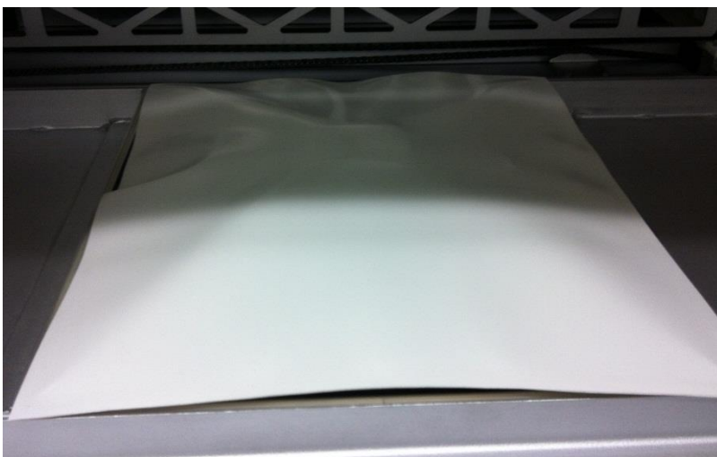
Abb. 9.7 ungenügend erwärmte Folie
