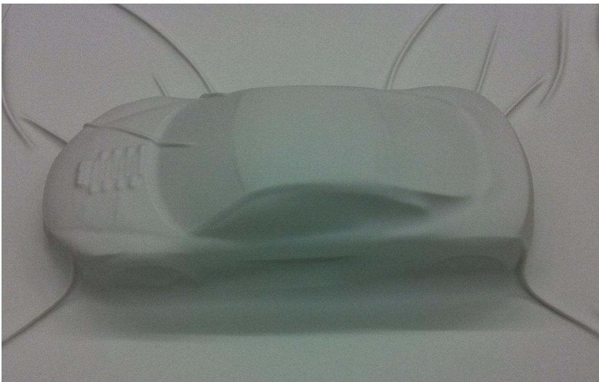
Abb. 9.9 abgeformtes Modell mit verstärkter Faltenbildung
