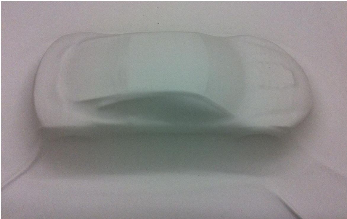
Abb. 9.8 abgeformtes Modell mit Faltenbildung
