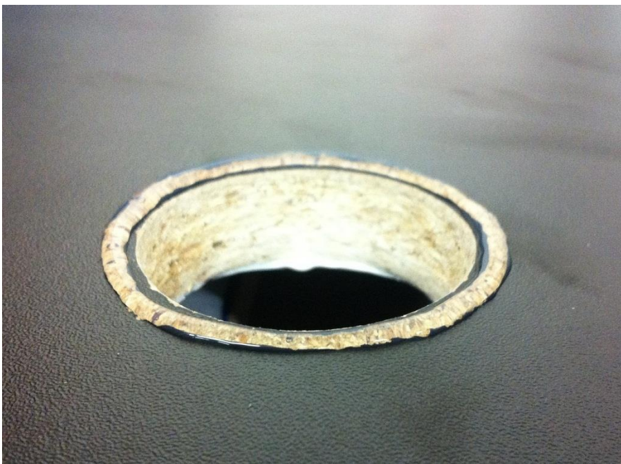
Abb. 9.13 Silikondichtung der Unterplatte
