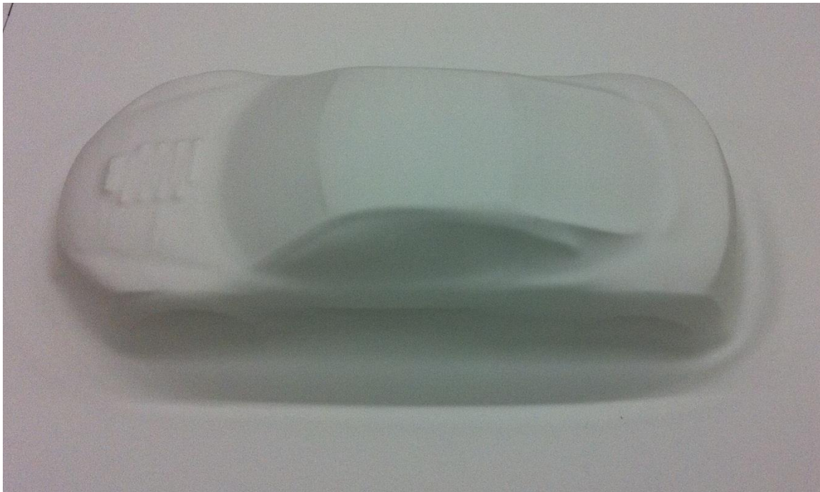
Abb. 9.10 abgeformtes Modell mit verringerter Vorblaszeit
