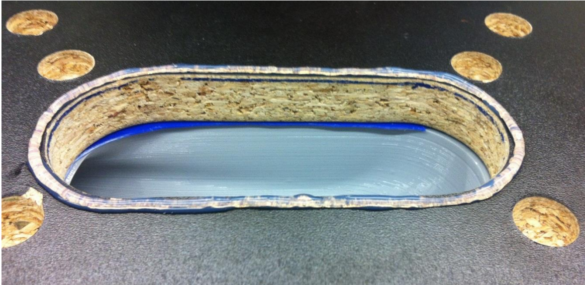
Abb. 9.12 Silikondichtung der Oberplatte
