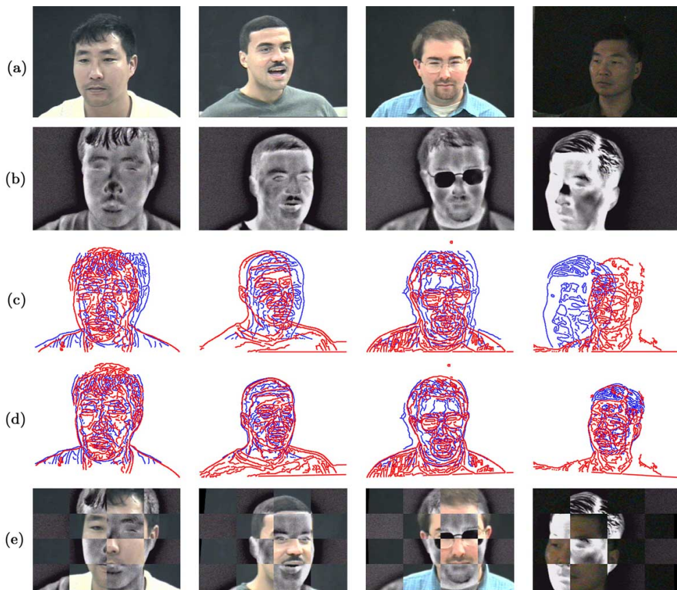
Abbildung 2.19.: Darstellung des Registrierungsprozesses: (a) visuelles Spektrum, (b) Thermografiebild, (c) Kantenextraktion und einfache Überlagerung (rot = visuelles Bild; blau = Thermografiebild), (d) registrierte Kantenextraktion, (e) Überlappung als Schachbrettmuster nach erfolgreicher Registrierung.
