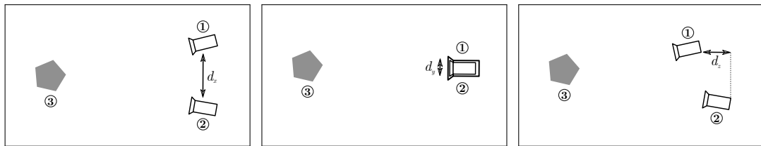
(a) Versatz der Kameras in der X-Achse um die Distanz d ( d_x ) (b) Versatz der Kameras in der Y-Achse um die Distanz d ( d_y ) (c) Versatz der Kameras in der Z-Achse um die Distanz d ( d_z )
