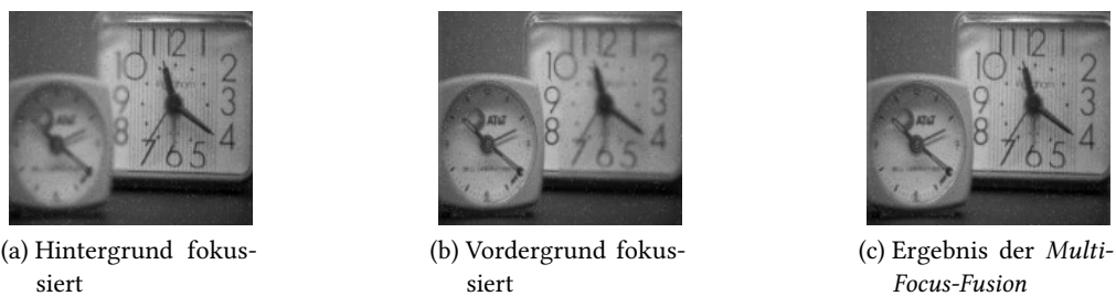
Abbildung 2.13.: Exemplarische Darstellung eines Verfahrens zur Multi-Focus-Fusion : (a)+(b) Eingangsbilder, (c) Ergebnis des Algorithmus FREQUENCY SELECTIVE WEIGHTED MEDIAN FILTER (FSWM) aus [Aslantas und Kurban (2009)].
