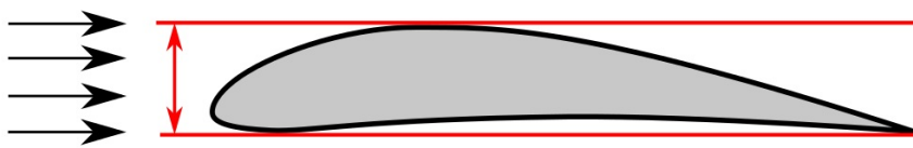
Abbildung 3.14: Anströmung einer Tragfläche mit einem Anstellwinkel von 0^\circ [Koe17]
