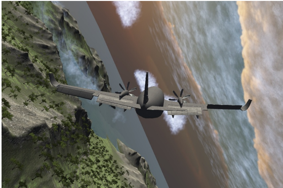
Abbildung 3.3: Voll ausgefahrene Flaps sowie voller Querruderausschlag [Koe17]
